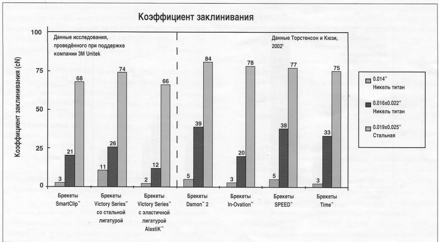
Рисунок 4 – Коэффициент заклинивания для всех комбинаций брекетов и дуг.
